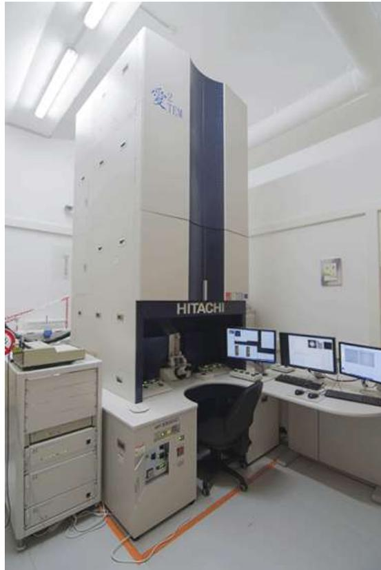
Figure 1 : le microscope électronique en transmission I2TEM
