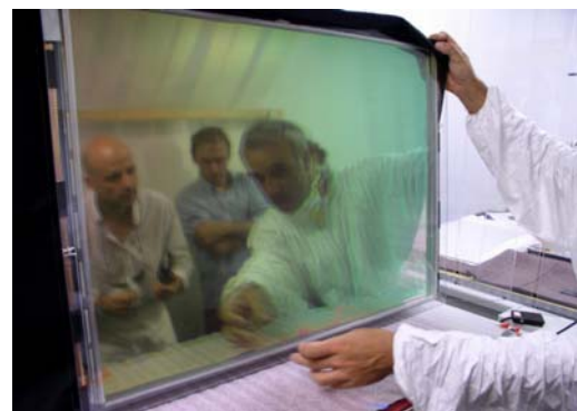
Fig. 2.- Prototype de vitrage intelligent réflecteur cholestérique élaboré au cours du programme européen Smart Win II auquel participait le CEMES
